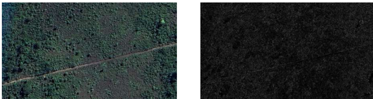
Figura 10 - Exemplo de imagem original e sua respectiva versão com o filtro Sobel.
